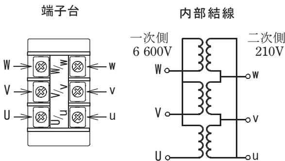
図3. 電磁開閉器代用の端子台説明図
