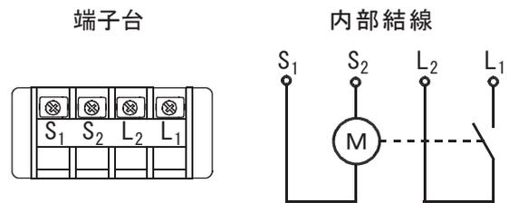
図4. 自動点滅器代用の端子台説明図
