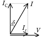
c ) 損失  $W = VI_r$ ,  $I_r = I_C \tan\delta$ ,  $I_C = \omega CV$  より,
