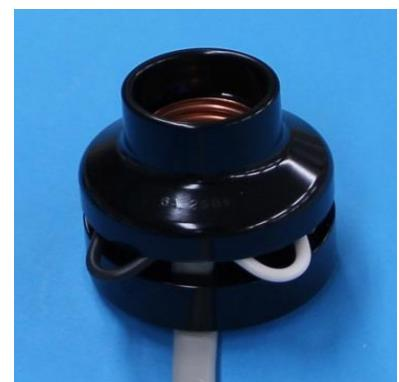
欠陥の例：絶縁被覆が長すぎるため、カバーが閉まらない
