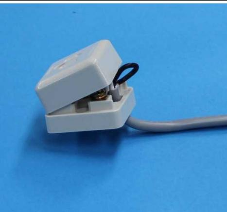
欠陥の例：絶縁被覆がはみ出ているため、カバーが閉まらない
