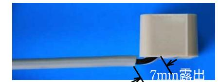
欠陥の例：絶縁被覆が 5mm 以上露出
