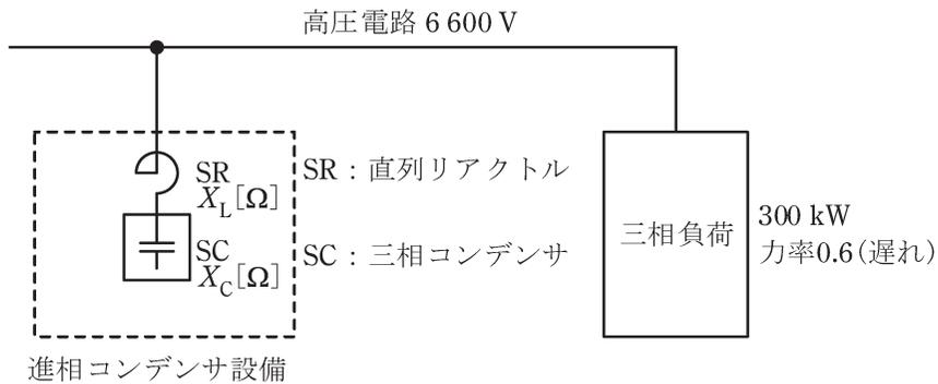
(a) 進相コンデンサ設備を高圧電路に接続したときに三相コンデンサ SC の端子電圧の値[V]として、最も近いものを次の(1)～(5)のうちから一つ選べ。
