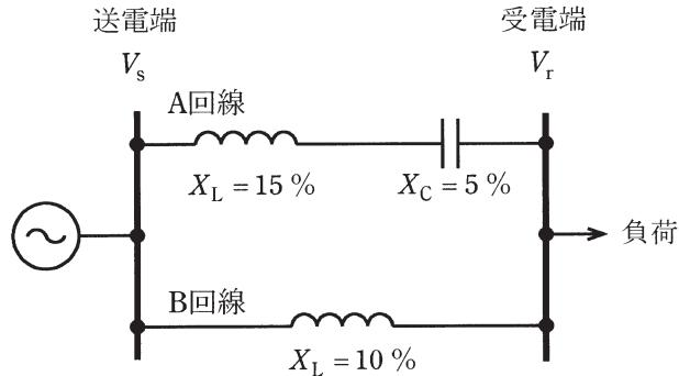
送電端と受電端の電圧位相差
