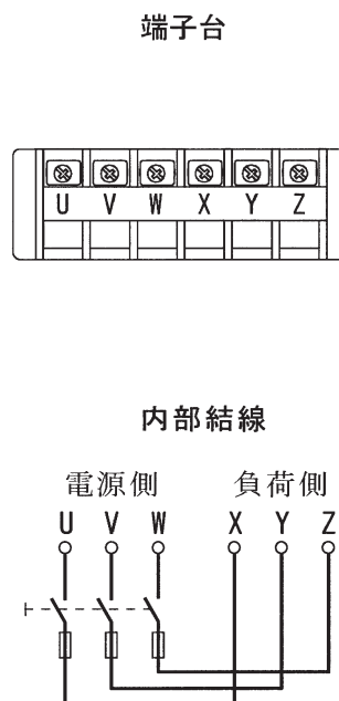
図3. 開閉器代用の端子台説明図
